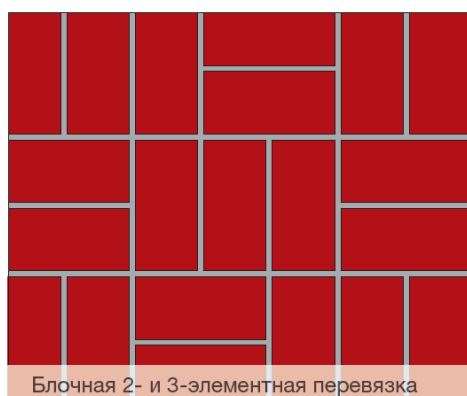
Блочная перевязка (на ребро и глашмя)
