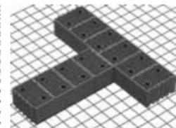
Перевязка с внутренней стеной толщиной 250 мм
