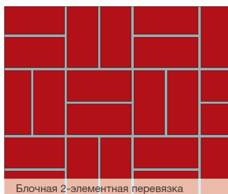
Блочная 1- и 2-элементная перевязка
